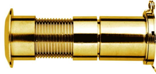
Con un diámetro de 24 mm, es adecuada para puertas con un grosor que va desde 38 mm hasta 70 mm, ofreciendo un amplio ángulo de visión de 180º. Fabricada con precisión en Latón torneado para el cuerpo y lentes de Cristal, la GEN se adapta a un amplio rango de puertas.
